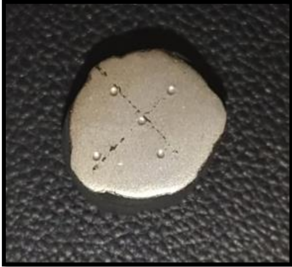
Figura 9 Probeta Post Ensayo de Dureza
