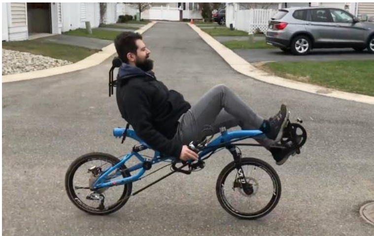
Figura 10. Sistema de direccion por debajo del asiento.
