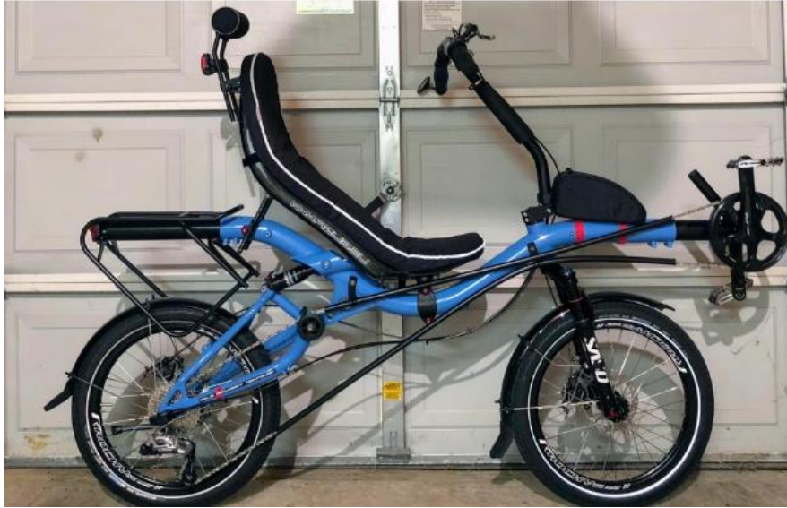
Figura 11. Sistema de dirección por encima del asiento.
