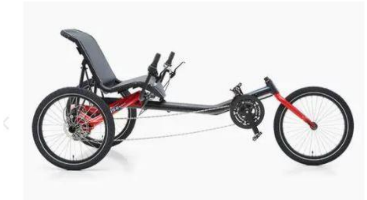
Figura 5. Estructura tipo delta.
