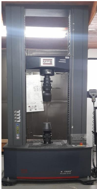
Figura 9. Máquina universal Exceed E45 – MTS
