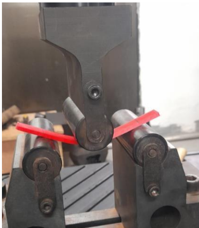
Figura 19. Ensayo de flexión
