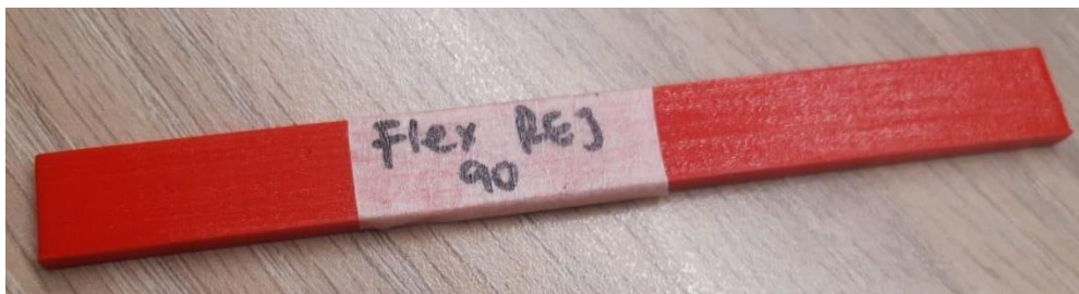
Figura 4. Probeta de flexión terminada
