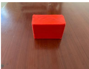
Figura 17. Impresión de probeta de compresión
