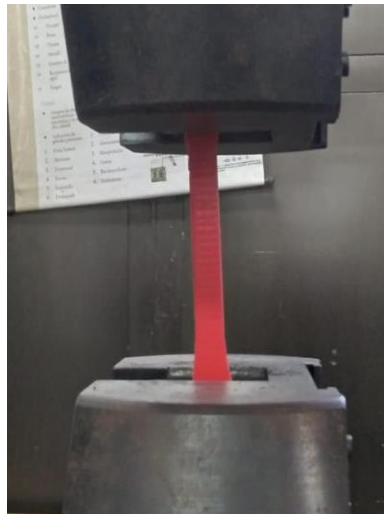
Figura 23. Ensayo de tensión
