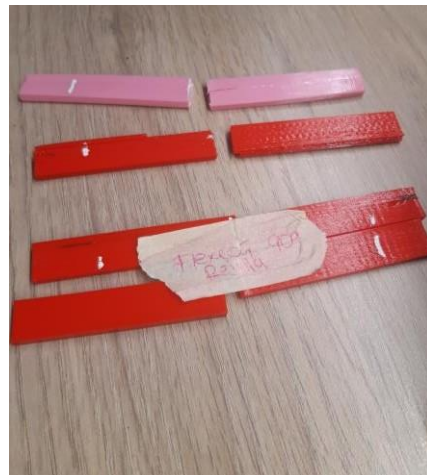
Figura 20. Probetas de flexión falladas
