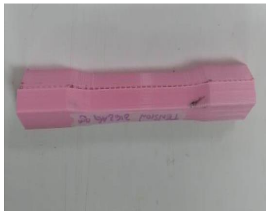
Figura 14. Probeta de tensión impresa con el árbol
