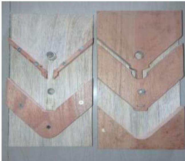
Imagen 29. Modelo de troquel diseñado en madera
