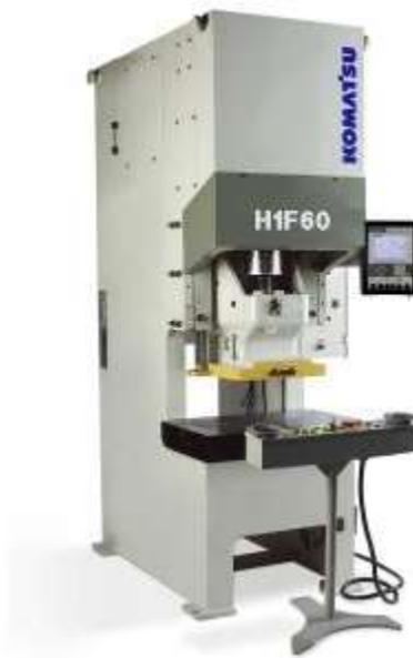
Imagen 15. Servoprensa. (Komatsu Press, s.f.)
