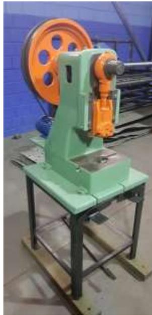
Imagen 35. Prensa mecánica excéntrica. (SHARKSTALITHA, s.f.)
