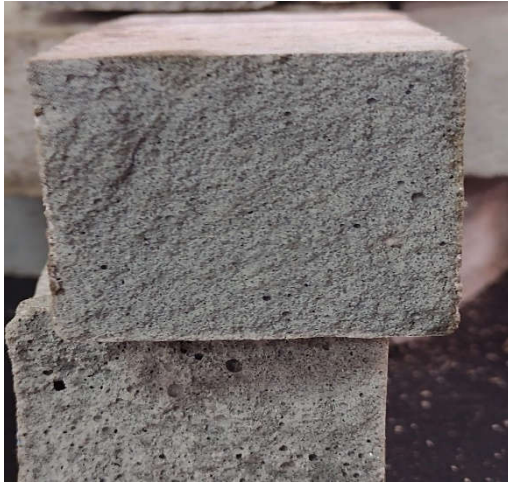
Ilustración 15 Muestra mortero fallada en Máquina universal a compresión
