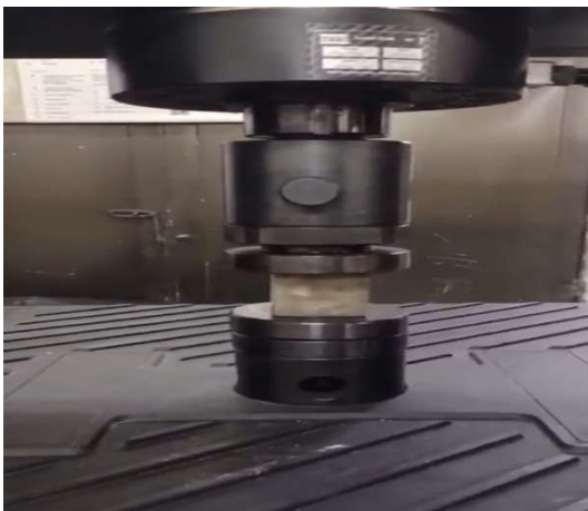
Ilustración 12 montaje a compresión
