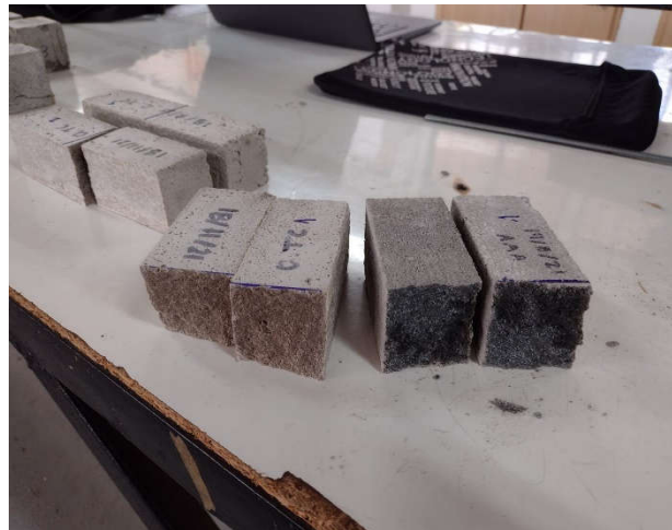
Ilustración 16 Muestra de mortero fallada en maquina universal a flexión
