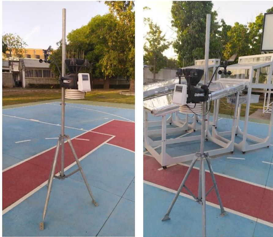
**Figura 3. Estación meteorológica**
