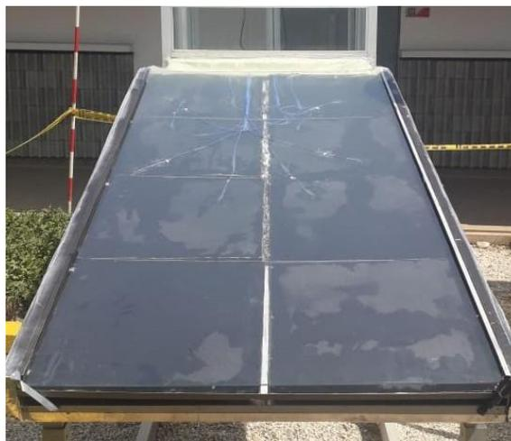
**Figura 2. Esquema de colector solar con PCM**
