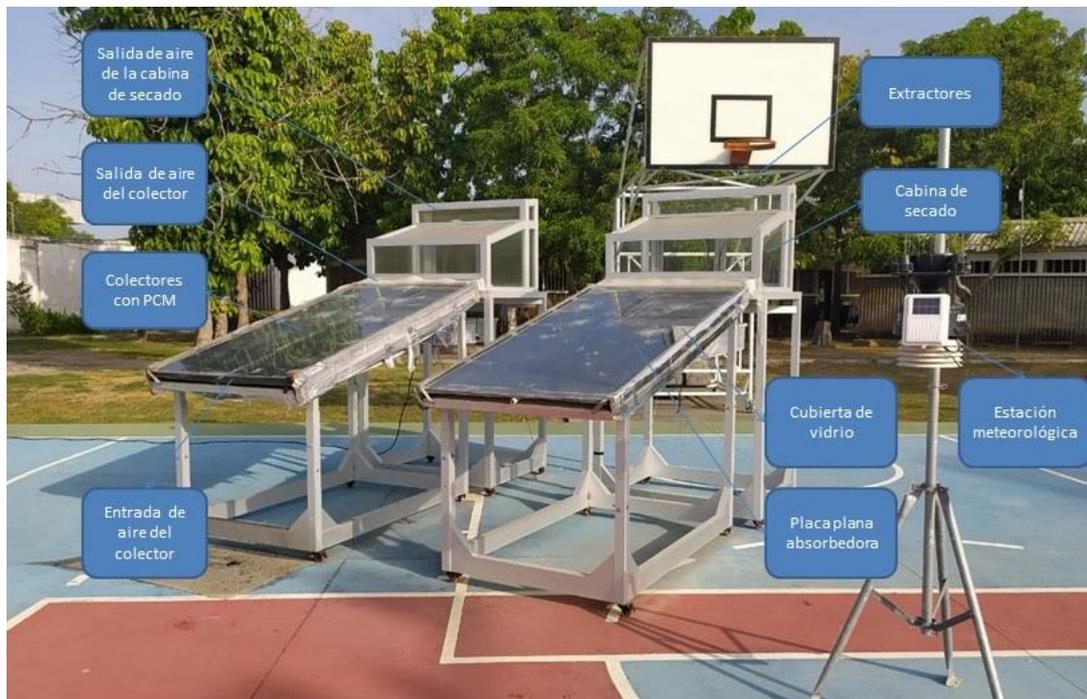
**Figura 5. Colectores solares y especificación de cada una de sus partes**
