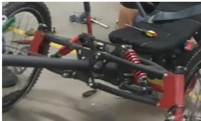
Figura 1 Sistema de suspensión en VTH arrancatetas 2016
