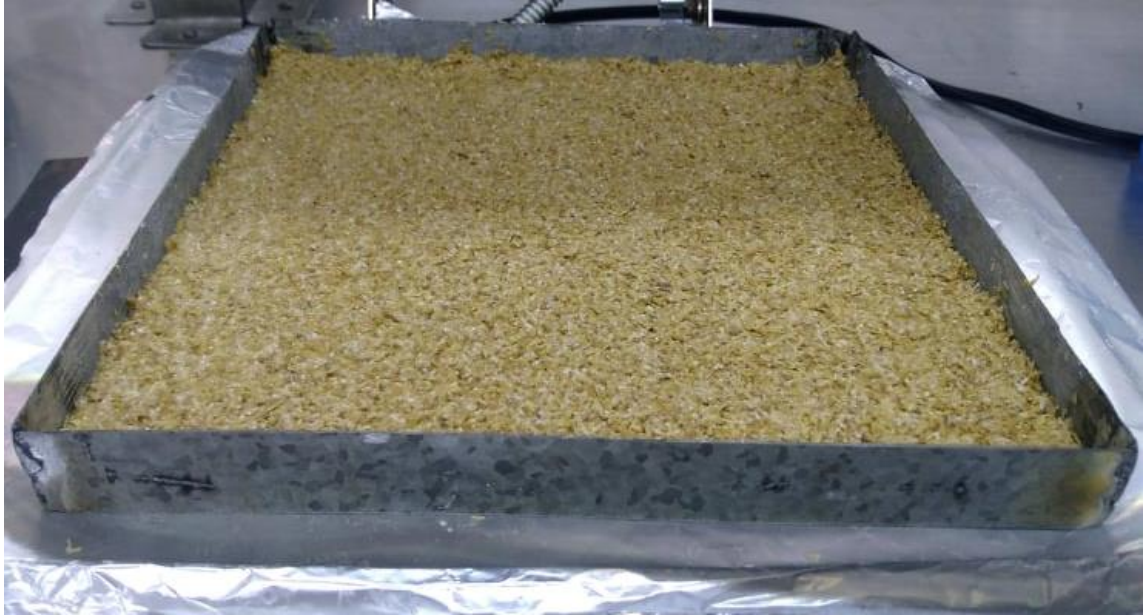
Figura 11. Moldeo previo al termoformado, con molde de 20 cm X 20 cm.
