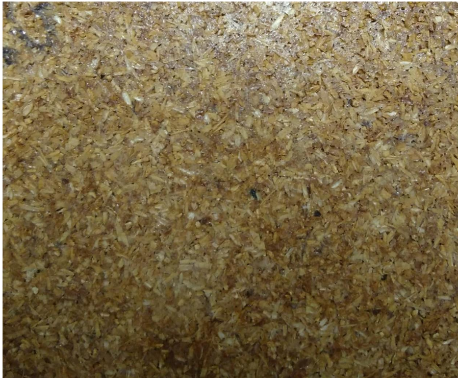
Figura 17. Material a base de harina de yuca (50%) y cascarilla de arroz (50%) con 5% glicerol.
