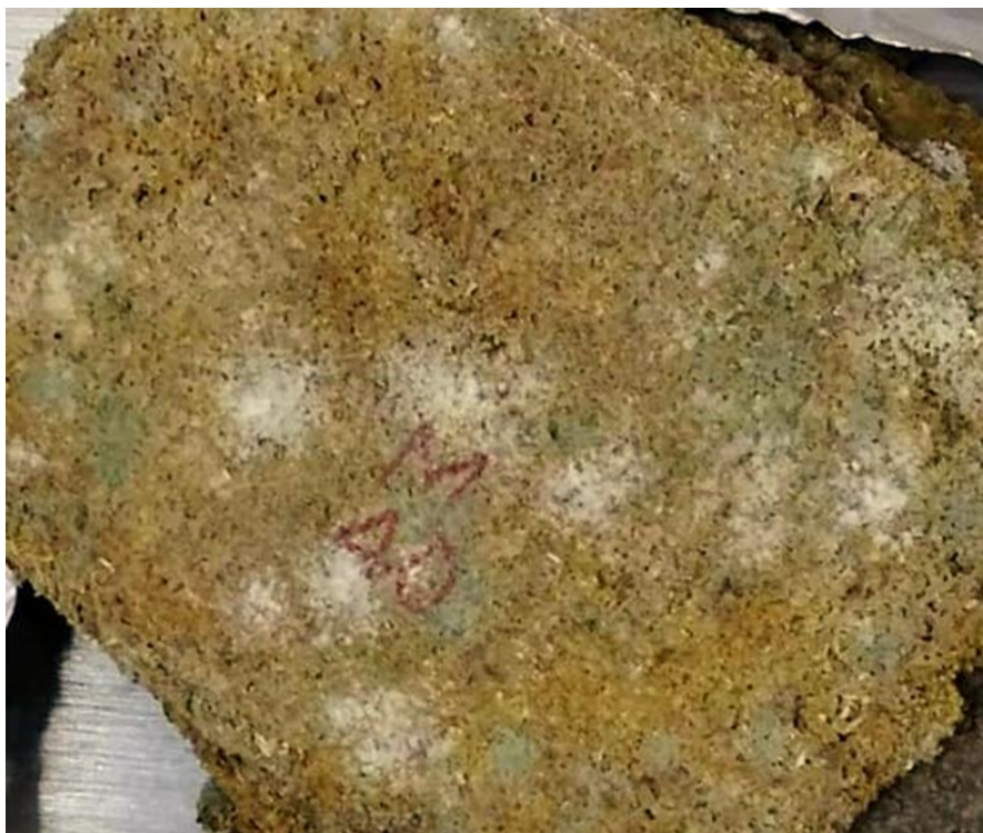
Figura 19. Material de la malla 40 con daño por hongos.
