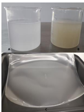
Figura 3. A) Solución filmógena de almidón oxidado b) solución filmógena de almidón nativo y c) película de almidón oxidado.
