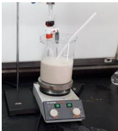
Figura 2. Montaje del proceso de oxidación de almidón
