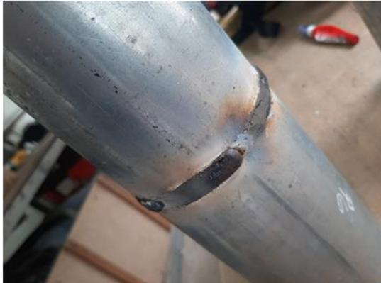
Figura No 24 Probeta 3 soldada y limpia, lista para ensayo
