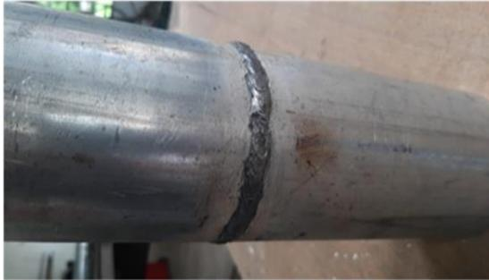
Figura No 22 Probeta 2 soldada y limpia, lista para ensayo
