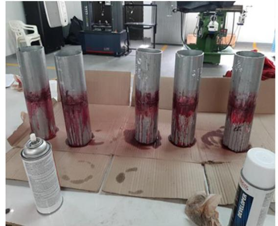
Figura No 18 Aplicación de líquido penetrante
