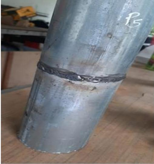
Figura No 28 Probeta 5 soldada y limpia, lista para ensayo
