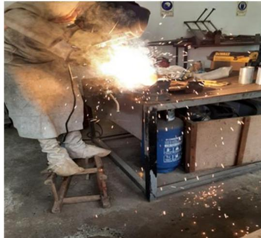
Figura No 14 Trazado de cordón de soldadura, posición plana
