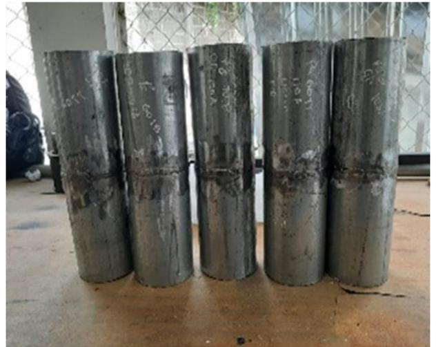
Figura No 16 Probetas soldadas listas para ensayos ED y END
