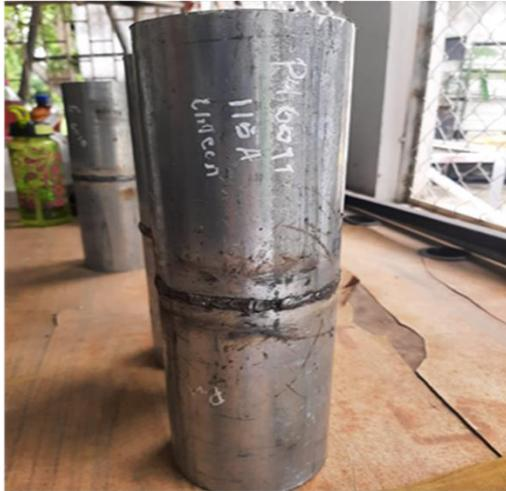
Figura No 26 Probeta 4 soldada y limpia, lista para ensayo
