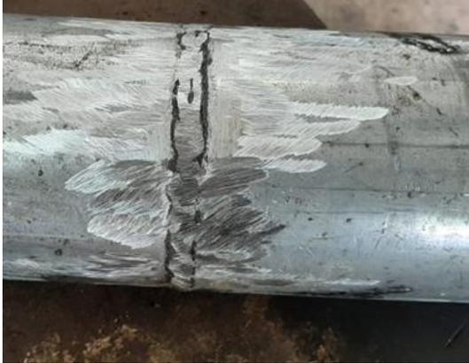
Figura No 20 Probeta 1 soldada y limpia, lista para ensayo
