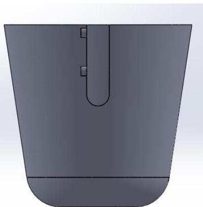
**Imagen 1.** *Diseño de socket mediante método de cono con punta truncada*
