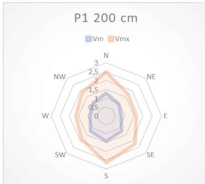
Figura N° 23: Rosas de viento con los datos del intercambiador a 200 cm de la primera recolección de datos.
