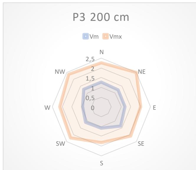
Figura N° 25: Rosas de viento con los datos del intercambiador a 200 cm de la tercera recolección de datos.
