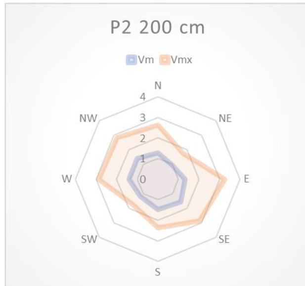
Figura N°24: Rosas de viento con los datos del intercambiador a 200 cm de la segunda recolección de datos.
