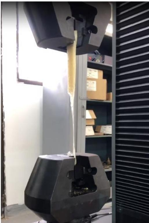
**Figura 30.** Ensayo de tensión. Elaboración propia
