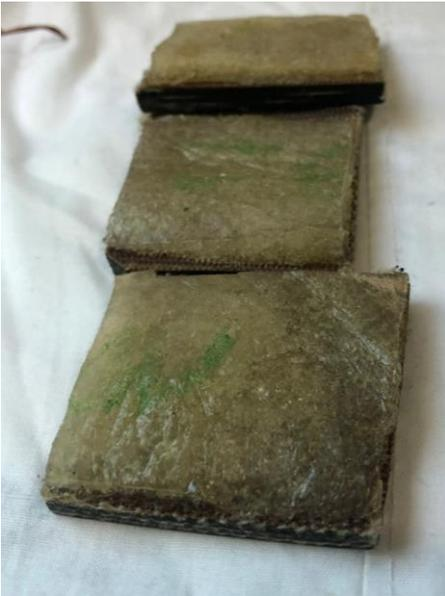
**Figura 25.** NBR adherido térmicamente a lona tipo industrial. Elaboración propia.
