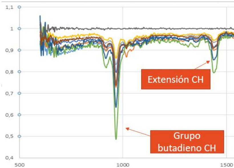
**Figura 27.** Espectro Infrarrojo de muestras replicadas de NBR empleadas en la modificación superficial de caucho comercial, después del tratamiento térmico de adhesión, caracterizadas por espectroscopia por transformada de Fourier (FTIR). Fuente: Elaboración propia.
