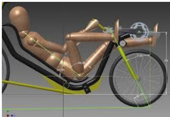
Figura 10. Referencia de la posición del piloto en un VTH y su inclinación con respecto a la horizontal.
