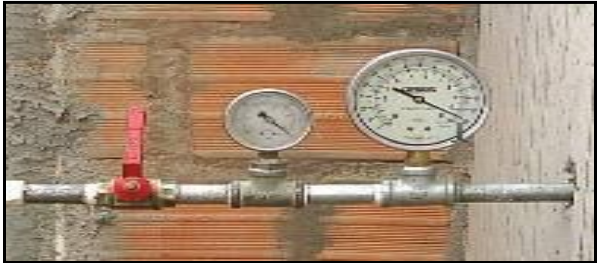
CALIBRACIÓN IN-SITU AL MANÓMETRO DE PRUEBA.
