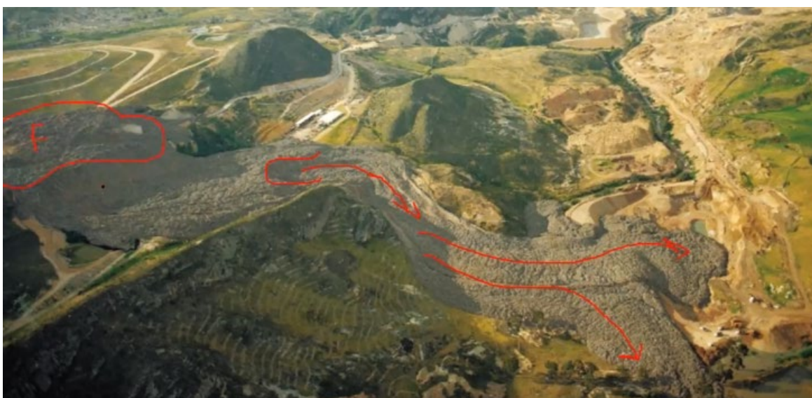
Imagen 35. Flujo del relleno sanitario Dona Juana de la ciudad de Bogotá con las direcciones del movimiento.
