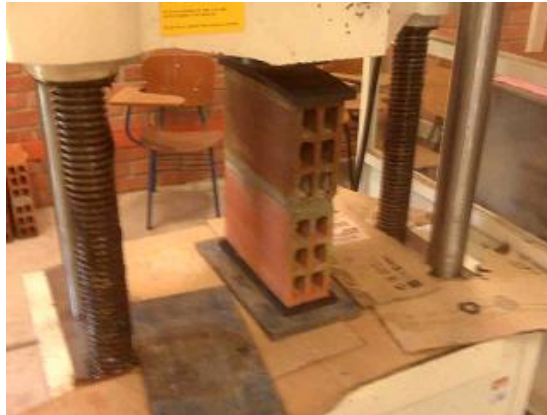
Figura 8. Ensayo a la compresión en muretes con neopreno.
