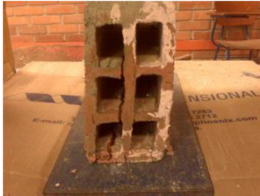
Figura 10. Falla de compresión en muretes y unidades de mampostería.
