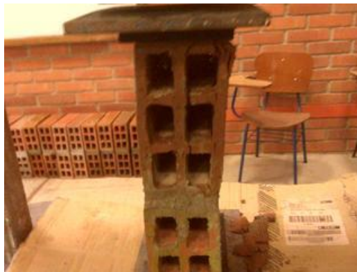
Figura 11. Falla de compresión en muretes y unidades de mampostería.
