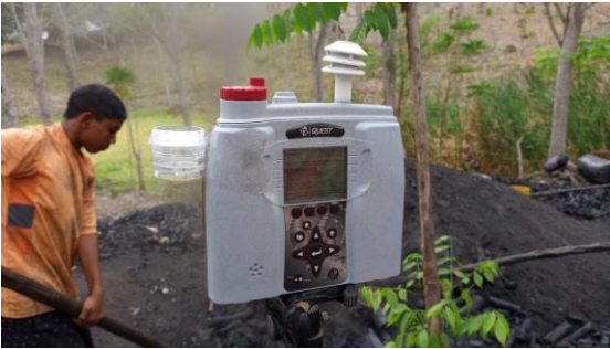
Figura 29 Medición de material particulado en campo
