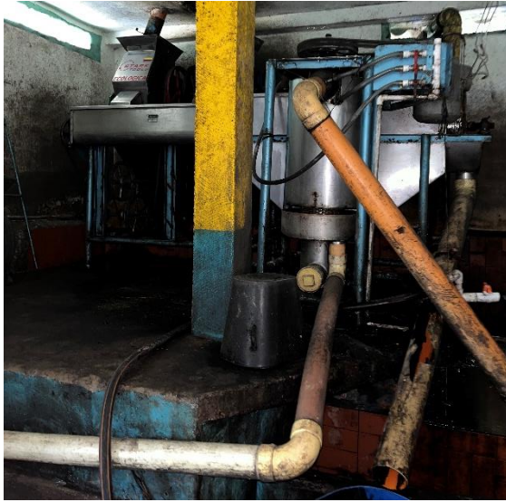
Figura 4. Despulpadora de café Autor: Carolina Bermúdez Rojas. Lugar: Finca La Macarena. Fecha: 28 de abril de 2024.
