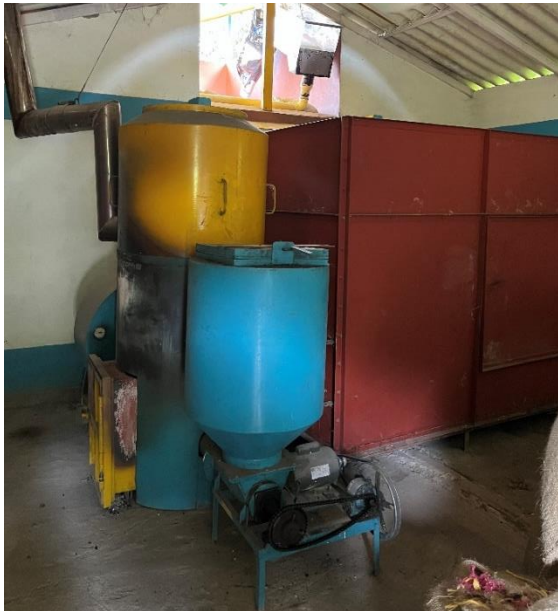
Figura 5. Secadora de café Autor: Carolina Bermúdez Rojas. Lugar: Finca La Macarena. Fecha: 28 de abril de 2024.
