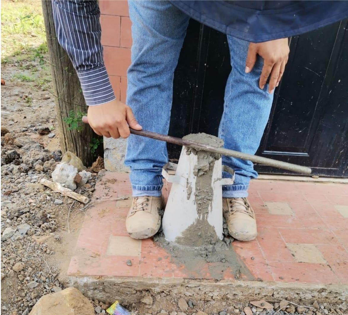
**Figura 10.** Pruebas en campo del concreto
