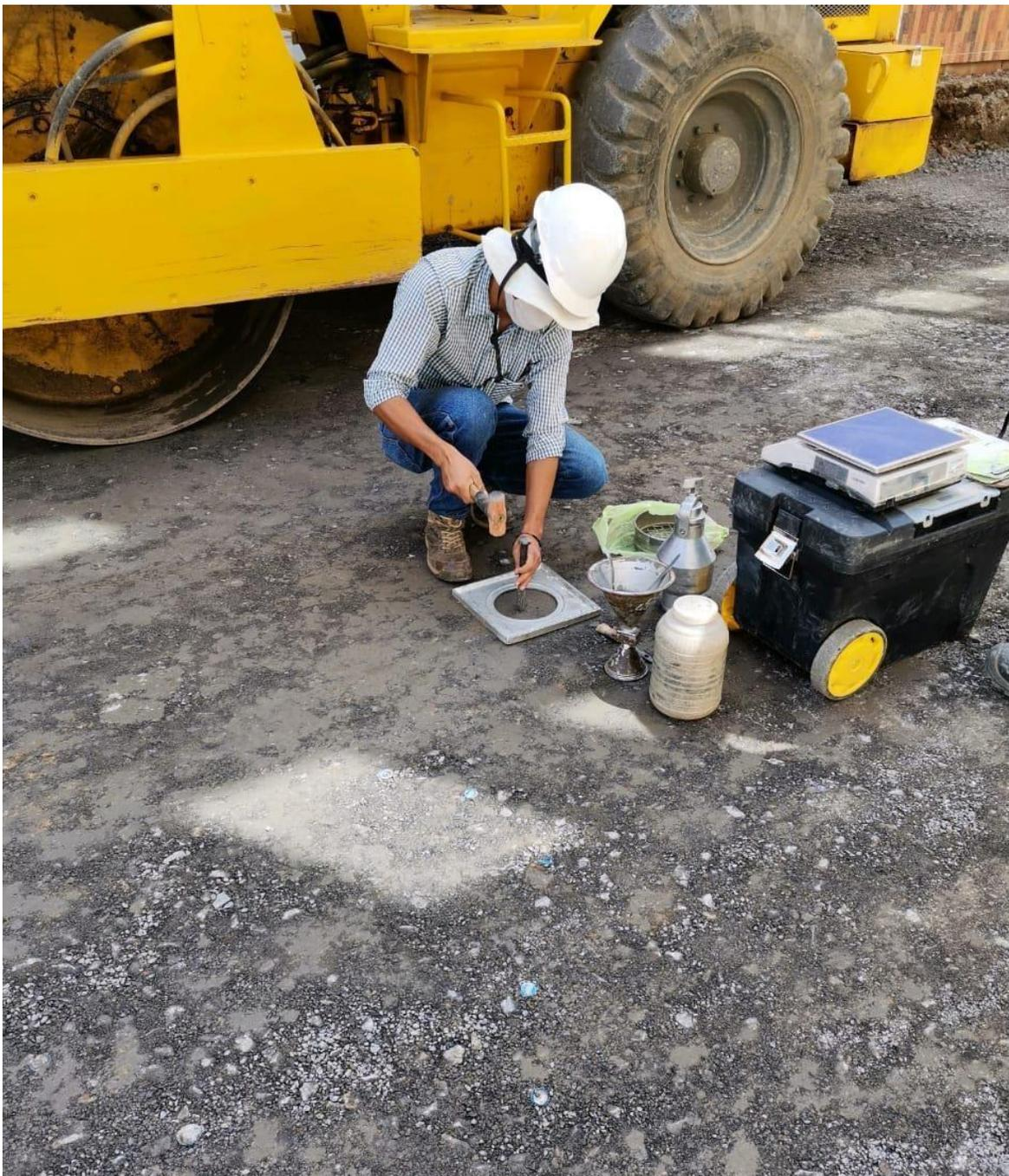
**Figura 8.** Ensayos en campo de las capas granulares
