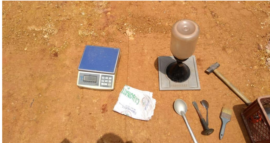
Imagen 46. Ejecución In-Situ de ensayo de cono de arena en obra Altos del Bosque
