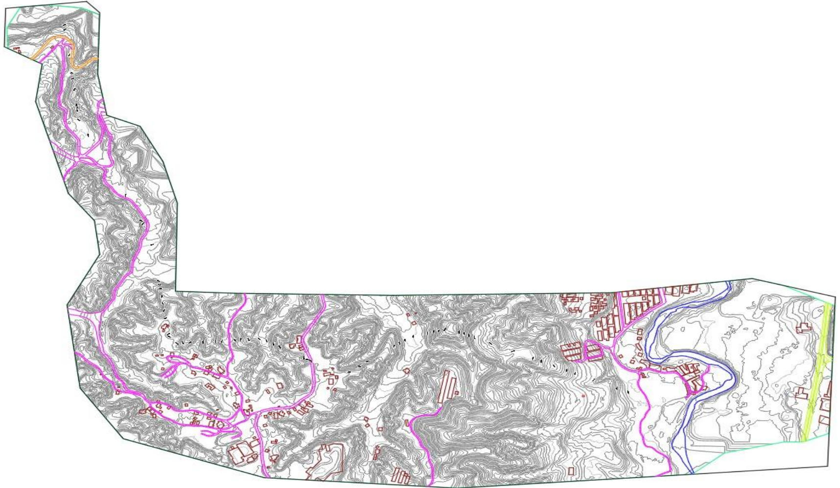
Imagen 43. Generación de Superficie basada en Curvas de nivel cada 2 metros Fuente: Pix4DMapper – Civil3D
