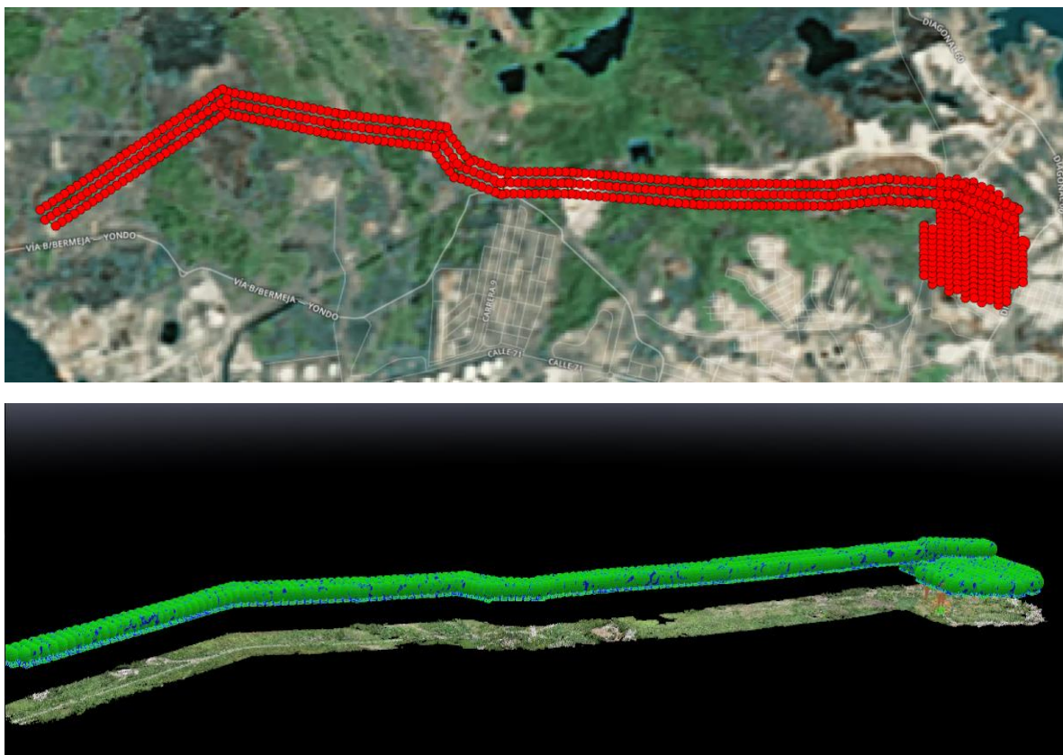
Imagen 19. Plan de vuelo para proyecto PTAR-Barranca, Fuente: Pix4DMapper – GoogleEarth pro
