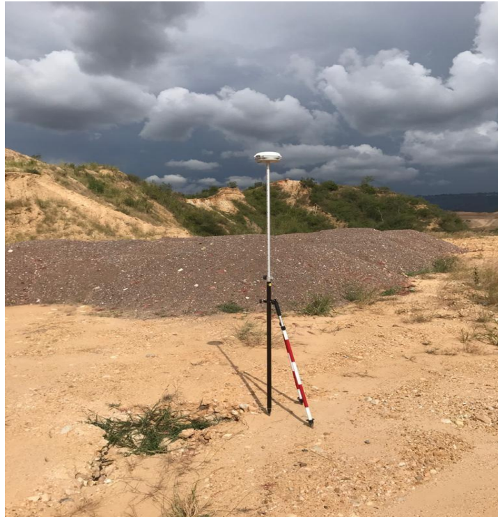
Imagen 40. Ubicación GPS-RTK X900 para vuelo Anillo Vial-Zapatoca, Fuente Propia
