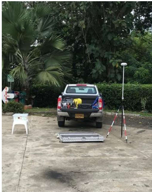
Imagen 35. Ubicación GPS-RTK X900 para proyecto Río Apartadó, Fuente: Propia
