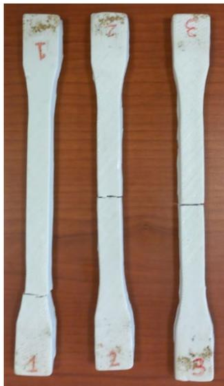
Ilustración 54 Probetas con ensayo de tensión finalizado.
