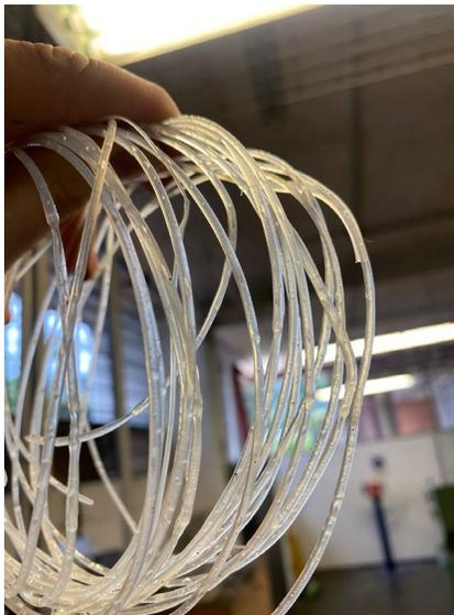
*Ilustración 20 Filamento con choque térmico*
