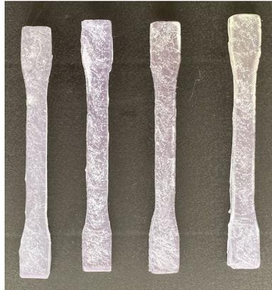
*Ilustración 52 Probetas PVC CRISTAL.*
