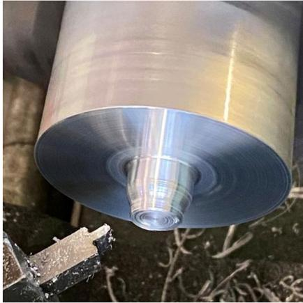
*Ilustración 24 Desgaste inicial con boquilla*
