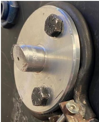
*Ilustración 27 Boquilla nueva instalada*
