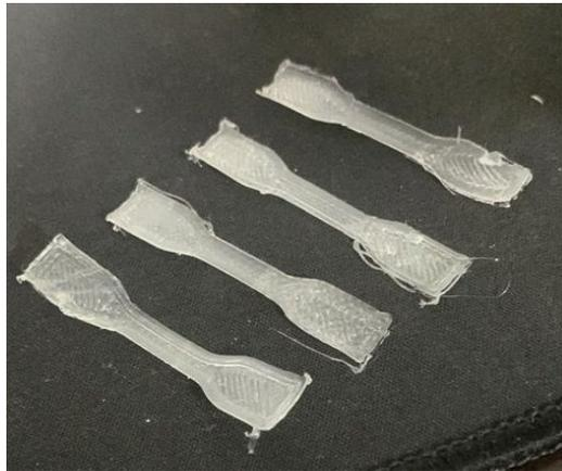
*Ilustración 48 Probetas HDPE.*
