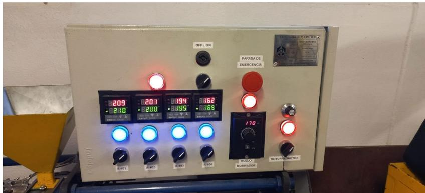
Ilustración 36 Temperaturas y velocidades (HDPE).
