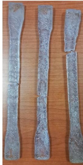
Ilustración 55 Probetas con ensayo de tensión finalizado.
