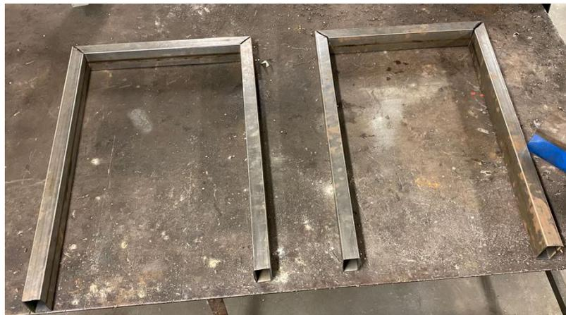
*Ilustración 10 Base metálicas soldados.*
