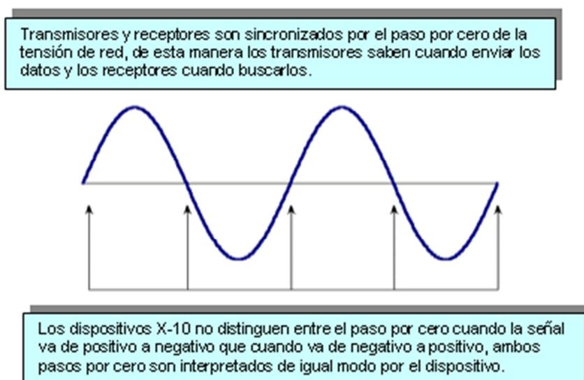
Un "1" binario del mensaje se representa por un pulso de 120kHz durante 1ms, en el paso por cero de la señal de red, y el "0" binario del mensaje se representa por la ausencia de ese pulso de 120kHz.
