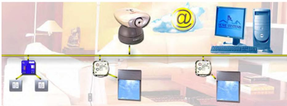
El control de persianas se realiza desde un pulsador convencional que acciona un micromódulo de aparato transmisor XTP139904 y de forma remota por internet a través de una Cryptocam CTT110501 que además sirve para realizar funciones de video vigilancia a la vivienda.
