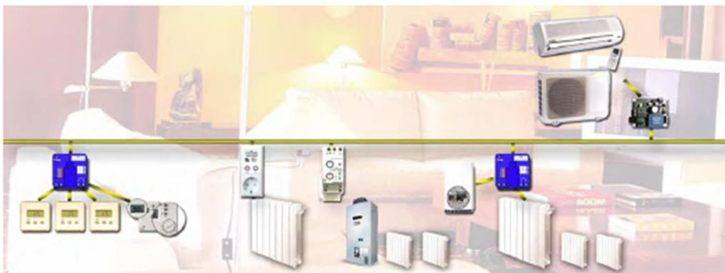
El control de temperatura se realiza mediante sondas termostáticas convencionales, cuya señal se envía a las calderas mediante un micromódulo de aparato transmisor XTP139904 y la activación de las mismas con módulos X-10 de diferente acabado.
