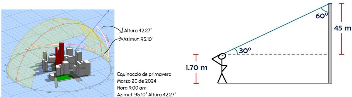
Figura 21 Azimut y altura del ángulo solar, imagen procesada en https://drajmarsh.bitbucket.io/sunpath3d.html
