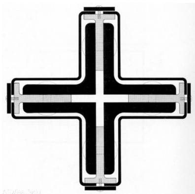
Imagen 5. (Rohe, Detalle columna cruciforme pabellón alemán en Barcelona, 1929)
