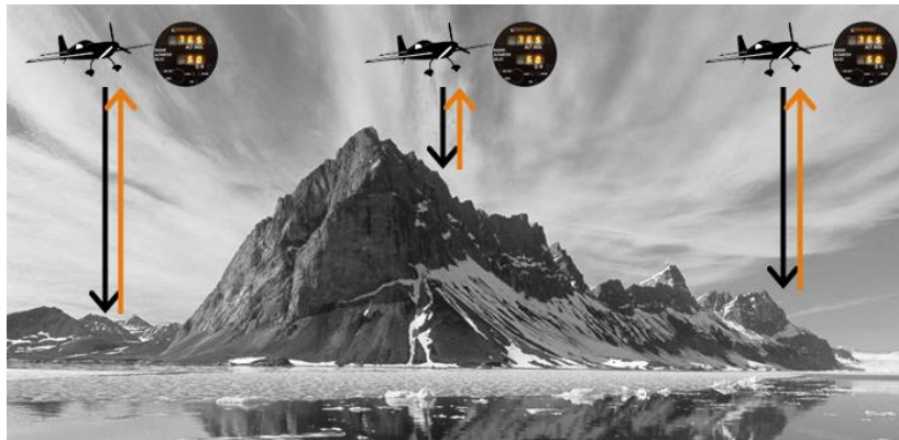
Ilustración 37. Principio del radioaltímetro 37
