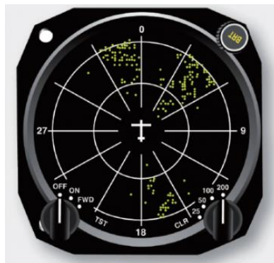
Ilustración 43. Stormscope, pantalla del detector de rayos 43
