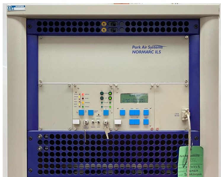
Ilustración 81. Módulo de control del Glideslope 81
