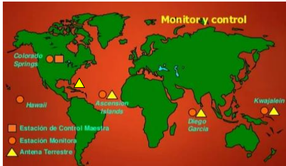
Ilustración 55. Segmento de control del GPS 55
