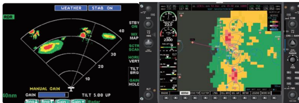
Ilustración 41. Radar meteorológico y display multifuncional de navegación 41
