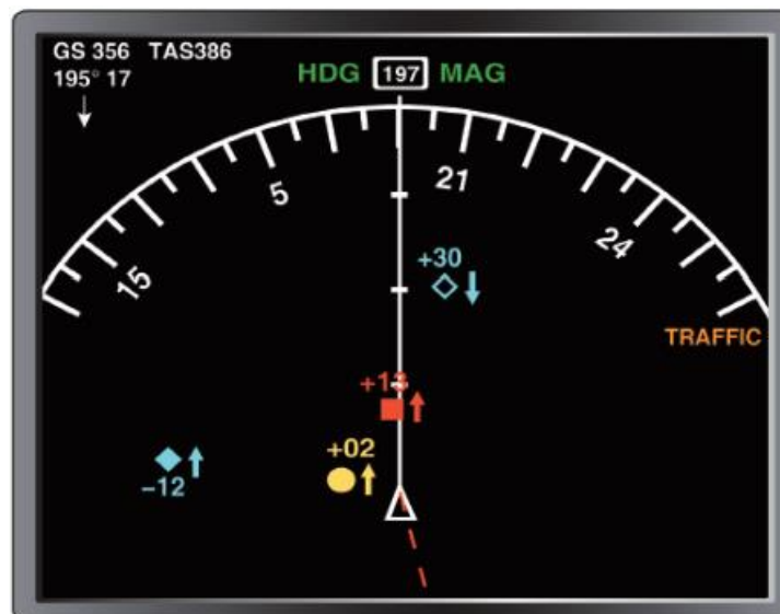
Ilustración 46. Monitor a bordo de la aeronave del TCAS 46
