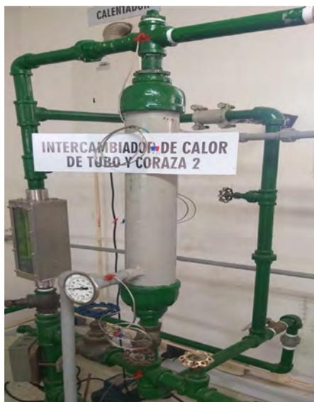
El intercambiador de tubos y coraza del laboratorio de térmicas está constituido por Coraza externa de acero inoxidable con diámetro nominal de 2.5 in, AISI 316
