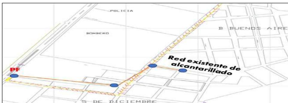
Ilustración 10 – Líneas de conducción de redes sanitarias al pozo final (PF).
