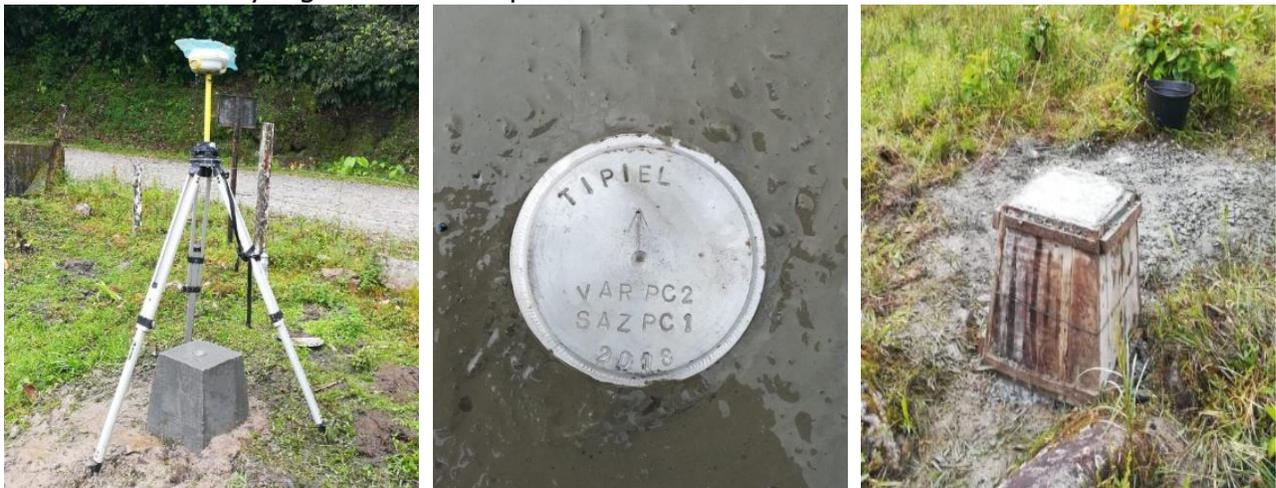
Ilustración 14. GPS doble Frecuencia R4, Mojón topográfico
