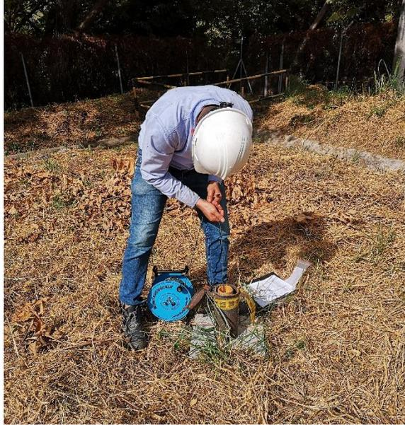
*Ilustración 19. Equipos de medición Water Level de Slope Indicator
