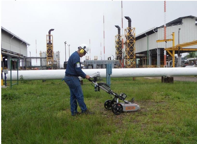
*Ilustración 1. Detección de enterrados con GPR
