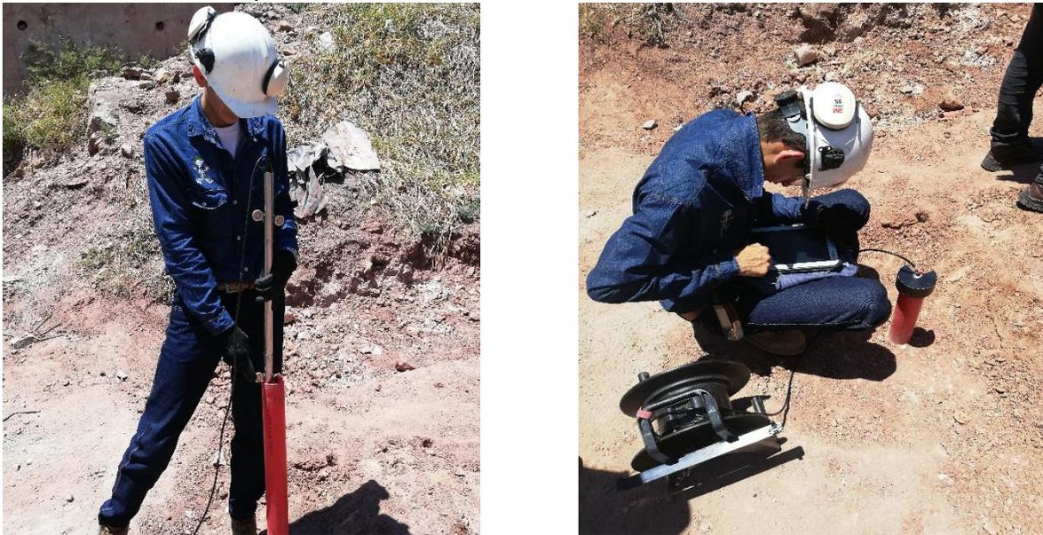
*Ilustración 18. Equipos de medición Slope Indicator
