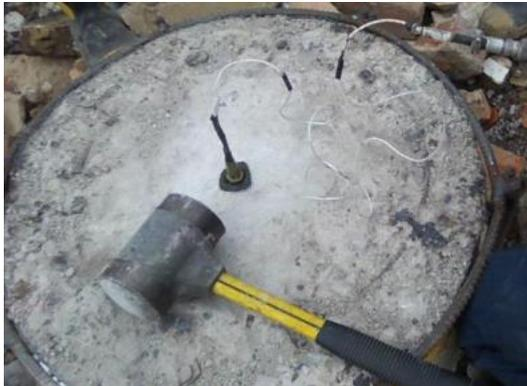
*Ilustración 12. Alistamiento de la cabeza del pilote* Fuente: Internet
