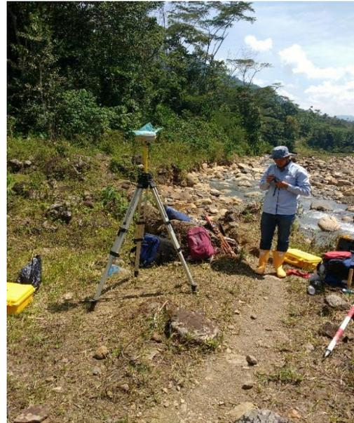
*Ilustración 15. Equipos de topografía y GPS doble frecuencia
