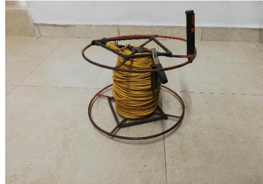
Cable de adquisición de datos
