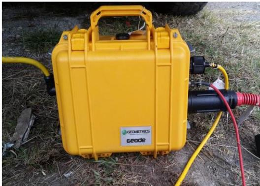
Sismógrafo GEODE 24CH
