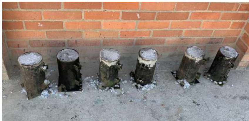
Figura 10 Muestras de Concreto
