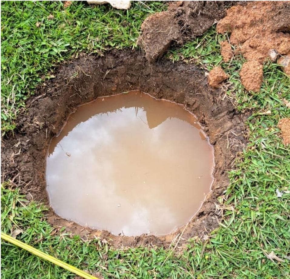
*Ilustración 11 Baja permeabilidad, empozamiento de aguas lluvias. Vereda La Magdalena, El Peñol. Registro propio, octubre 2022*
