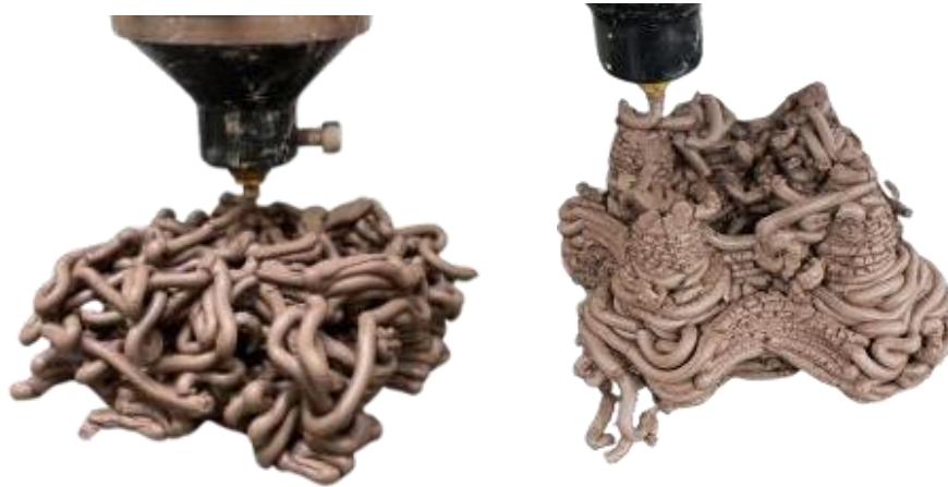
Figura 7 Colapso de modelos durante el proceso de impresión
