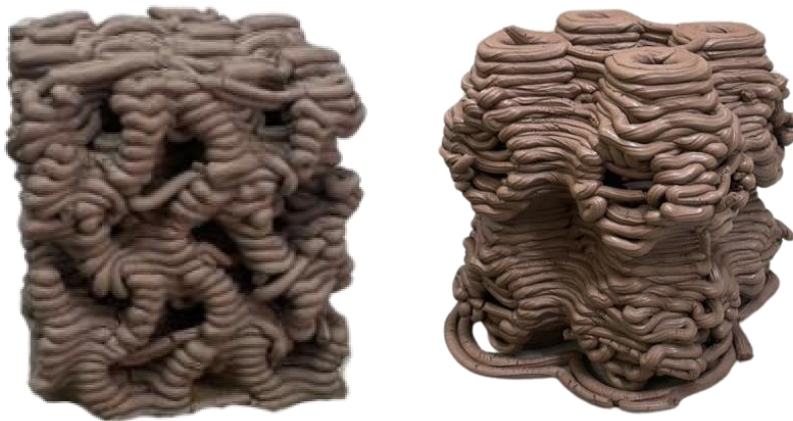
Figura 6 Estructuras Gyroid y Schwarz impresas con una capa de 3mm
