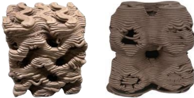
Figura 6 Estructuras Gyroid y Schwarz impresas con una capa de 3mm
