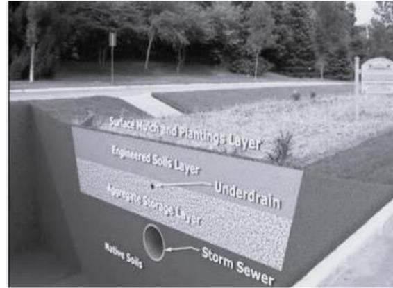
Ilustración 17. Dren filtrante con capas granulares Fuente: lineamientos del componente paisajístico EAAB
