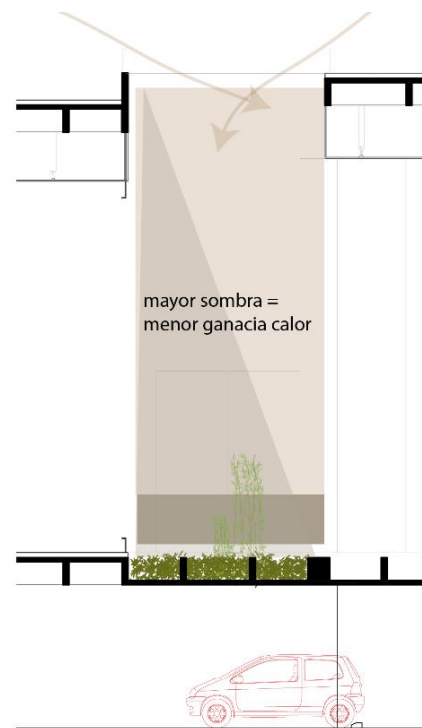
Ilustración 46. Sección patio configuración formal 1 (aumentar la altura) comportamiento térmico identificado. ilustración propia
