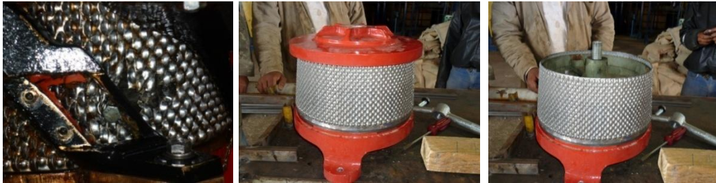
Ilustración23. Camisa rota y colocación de la nueva
