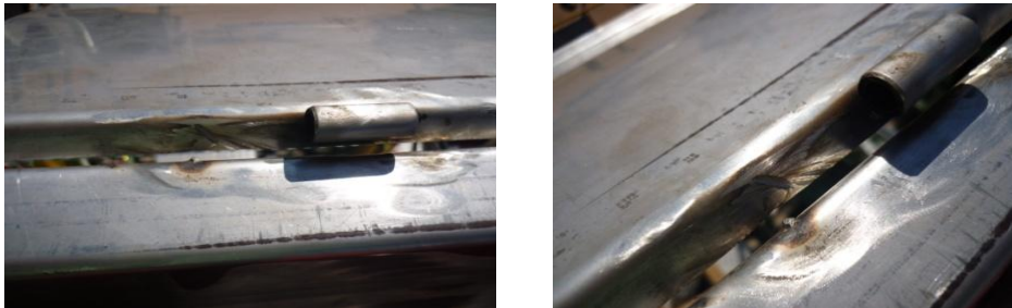
Ilustración28. Pegue de soldadura tapas sinfín de pulpas
