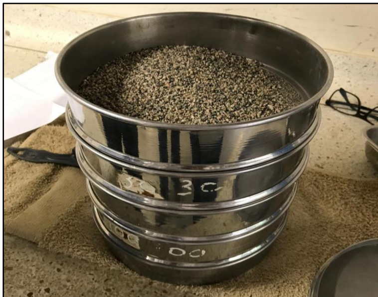
Imagen 4: Juego de tamices para Ensayo de Granulometría
