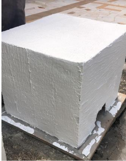
Figura 11. Módulo en ladrillo H-10 finalizado con recubrimiento aplicado
