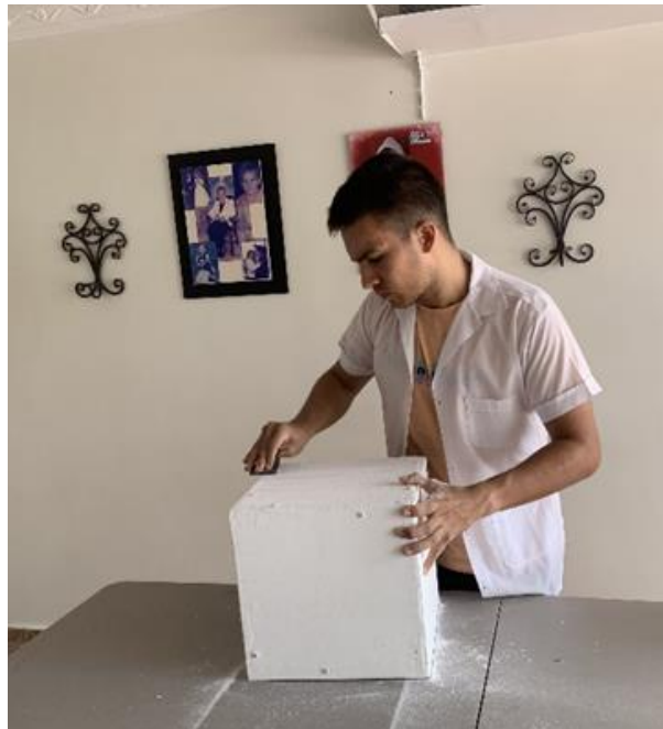
Figura 24. Lijado final de módulo de Super board.
