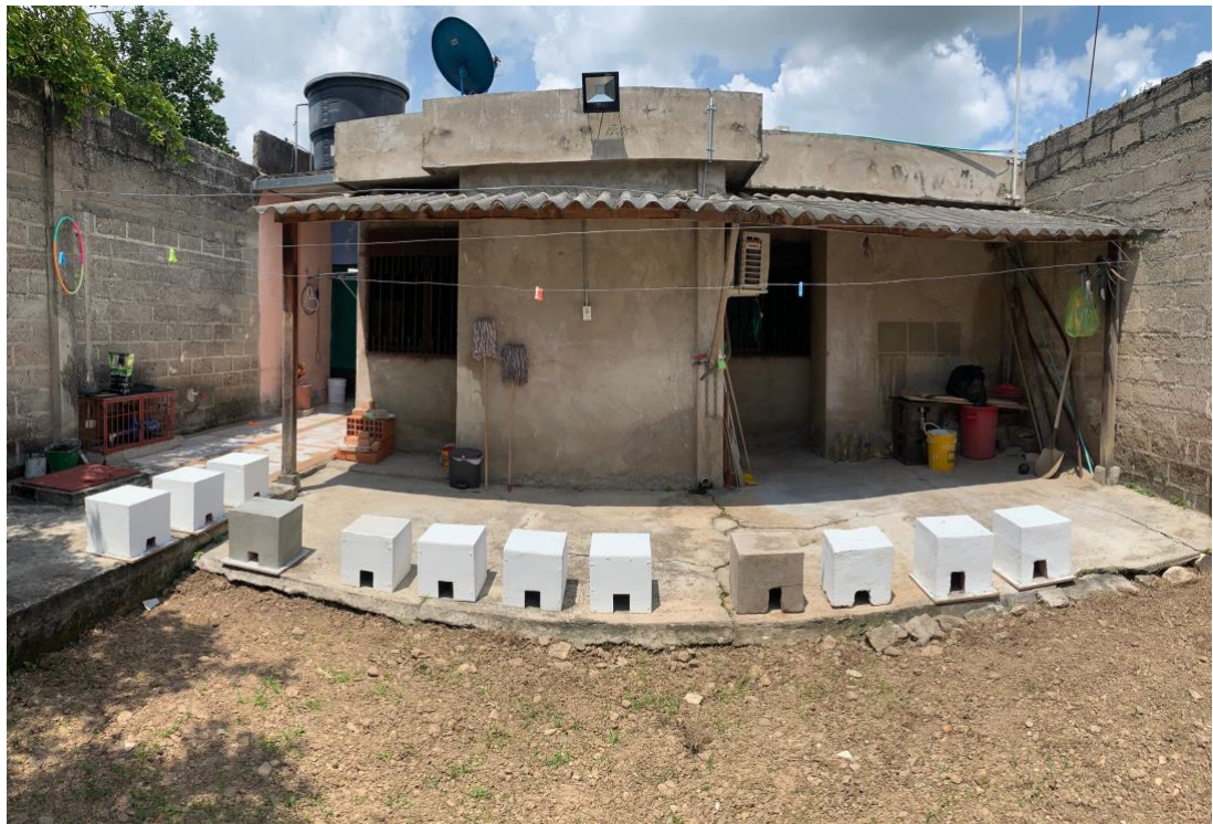
Figura 4. Módulos en proceso de curado expuestos a la intemperie
