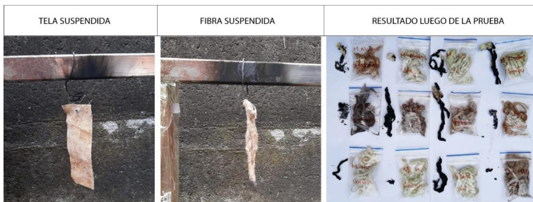
Figura 9: Prueba de fuego en tela 70% algodón 30% poliéster y fibra de 100% algodón.
