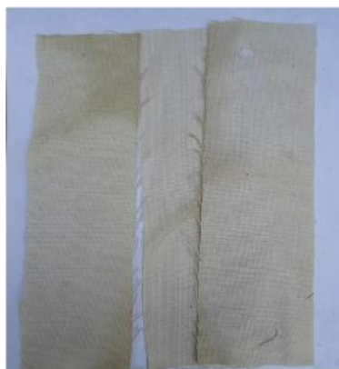
Figura 8: Muestras de tela cortadas con una medida de 10x3cm. Fotografía de los autores.
