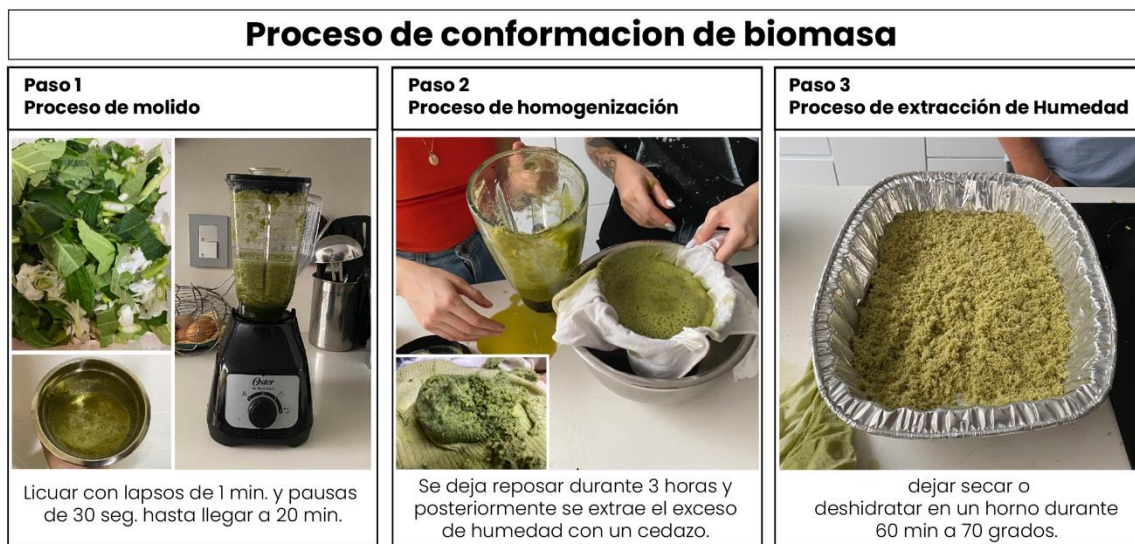
Figura 13. Proceso de conformación de biomasa. Figura de los autores.
