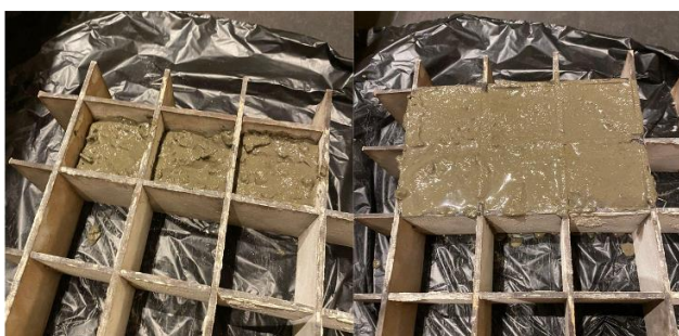
Figura 8. Proceso de vaciado y eliminación del aire acumulado. Fotografía de los autores
