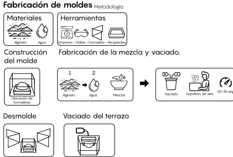
Figura 26. Esquema que representa la fabricación de moldes de alginato. Esquema de los autores.
