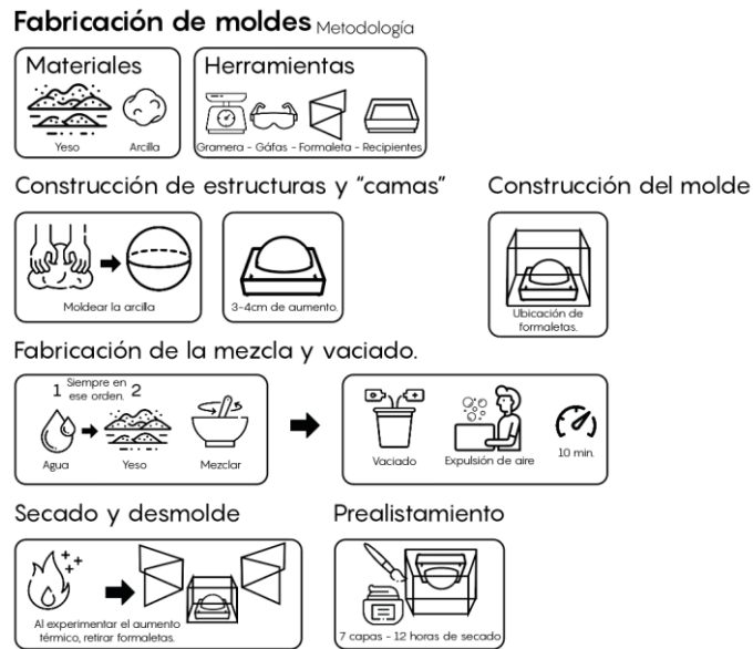
Figura 21. Este esquema representa la fabricación de moldes en yeso. Esquema de los autores.
