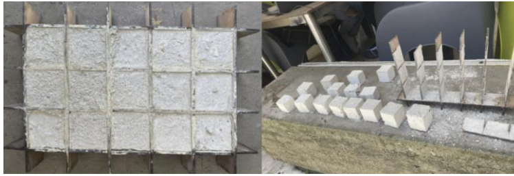
Figura 14. Imagen de proceso de desmolde y evidencia de características del material. Fotografía de los autores.
