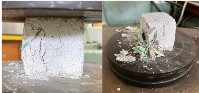
Figura 15. Posicionamiento de las probetas en el centro de la prensa de la máquina universal. Fotografía de los autores.
