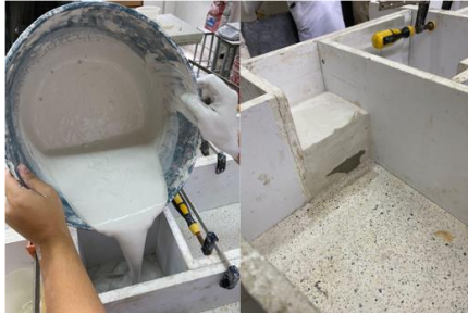
Figura 23. Proceso de vaciado y extracción del molde final. Fotografía de los autores.
