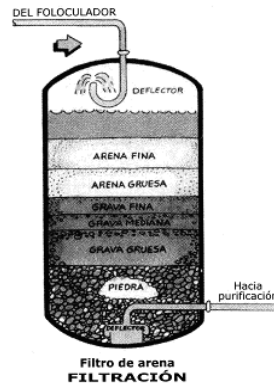
Figura 3. Proceso de Filtración
