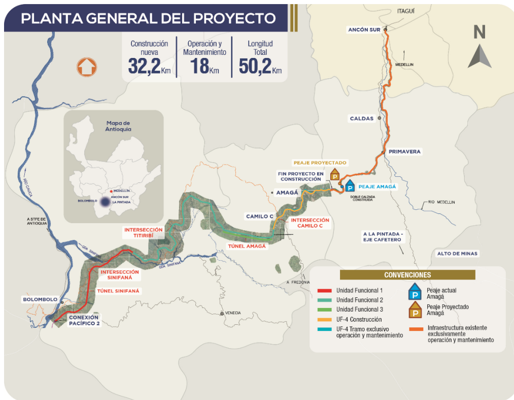
Figura 16 Planta general Conexión Pacífico 1
