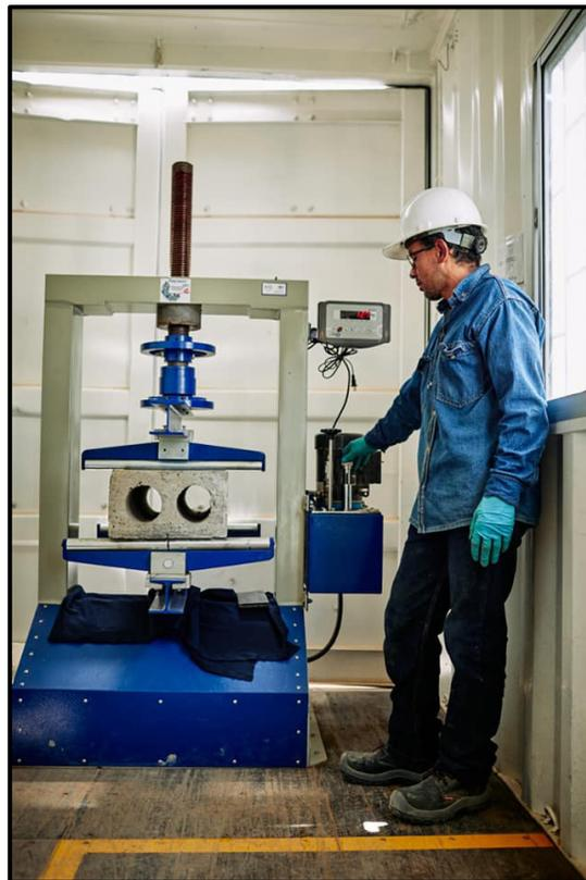
*Figura 11 - Ensayo de compresión bloque prefabricado producido en RECICLADOS INDUSTRIALES S.A.S.; fuente: Facebook RI S.A.S.*
