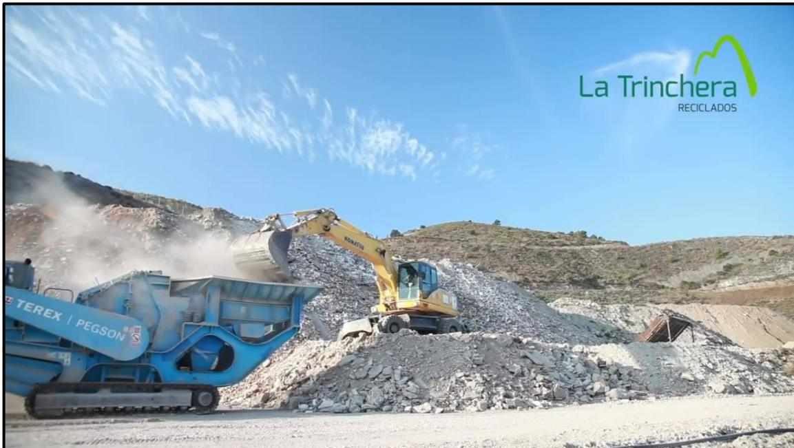
Figura 18 - Trituración, Planta RCD RECICLADOS LA TRINCHERA S.L.; fuente: Facebook Reciclados la trinchera
