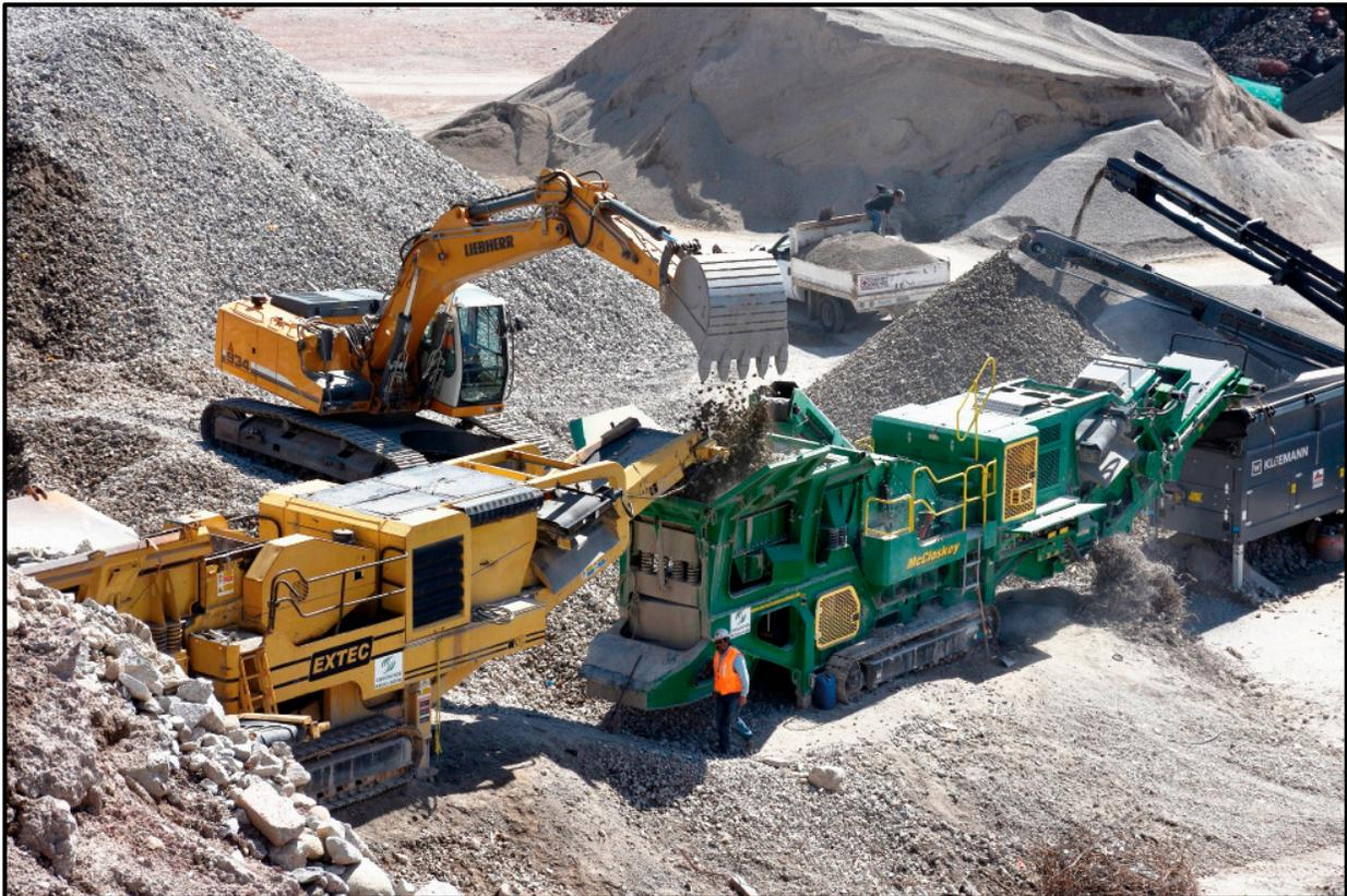
*Figura 5 - Planta RCD CONCRETO RECICLADO, México D.F.; Fuente: Facebook CONCRETOS RECICLADOS S.A.*
