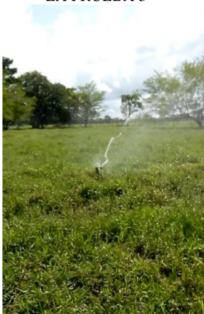
ILUSTRACIÓN 92 FUNCIONAMIENTO DEL ASPERSOR 5123PC DURANTE LA PRUEBA 3
