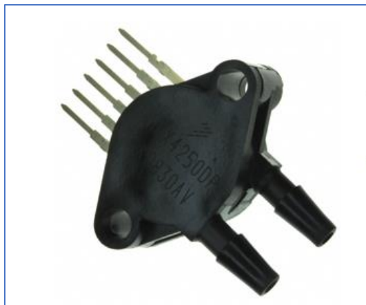
ILUSTRACIÓN 120 SENSOR DE PRESION TIPO MANOMETRO 72 .5 PSI
