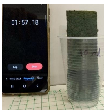
Figura 31: Muestra de capilaridad 1 con volumen de 10ml.
