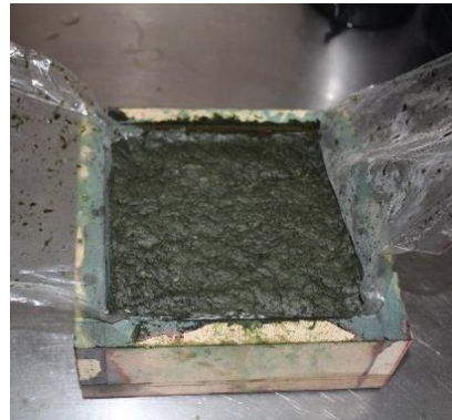
Figura 13: Ubicación de la muestra en el molde
