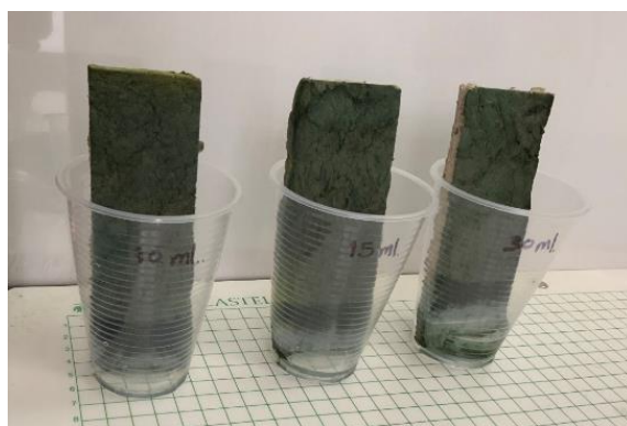
Figura 30: Muestras de capilaridad y volumen aplicado.
