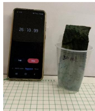
Figura 33: Muestra de capilaridad 3 con volumen de 30ml.
