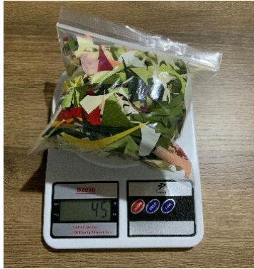
Figura 6: Pesado inicial de la muestra (45g)
