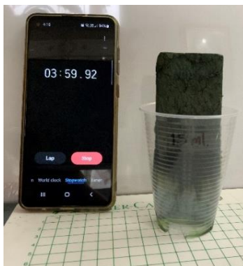
Figura 32: Muestra de capilaridad 2 con volumen de 15ml.
