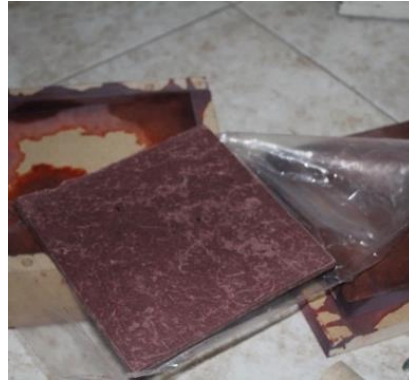
Figura 15: Desmoldado de la muestra
