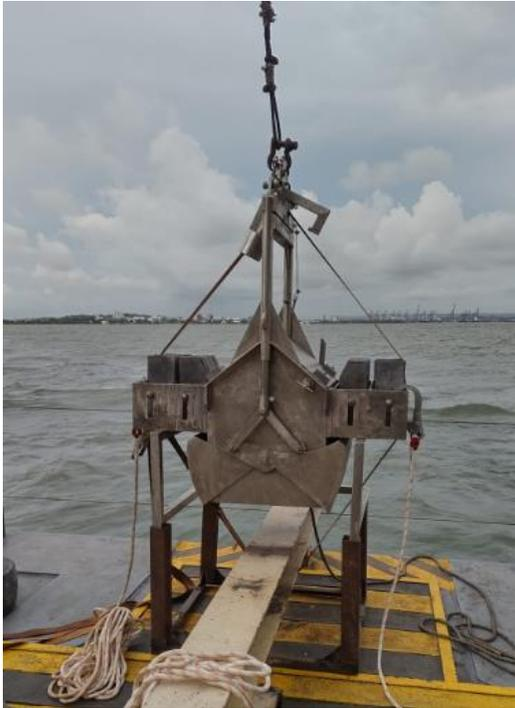
**Figura 1 - Figure 1.** Box Corer de 50x50x50 cm, empleado para la toma de muestras de macrofauna. Box Corer of 50x50x50 cm, used for taking samples of macrofauna.
