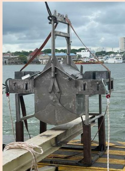
Antes del zarpe oficial, se realizaron pruebas del equipo Box Corer en las inmediaciones de la bahía de Cartagena, todo con el fin de determinar la ubicación ideal de este muestreador dentro de la embarcación, calibrar la plomada óptima para la toma de muestras, revisar la resistencia del winche con la muestra ya extraída y abordar cualquier otro obstáculo que pudiera surgir durante los lances en las estaciones.
