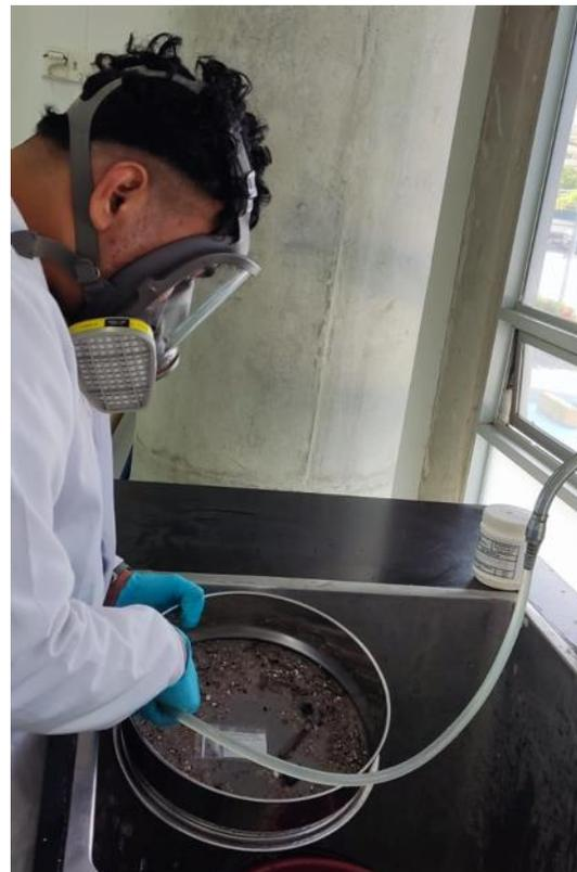
**Figura 10 – Figure 10.** Lavado de las muestras en el laboratorio. Washing of samples in the laboratory.
