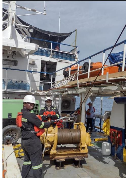
**Figura 2 – Figure 2.** Guaya y winche oceanográfico empleado para el lance e izaje del Box Corer. Wire Rope cable and oceanographic winch used to launch and hoist the Box Corer.
