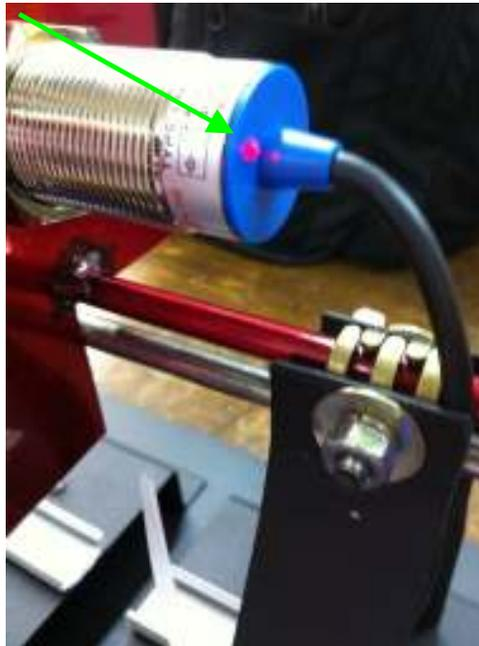
4. Un procedimiento más de preparación previo al desarrollo de la práctica sería chequear con el multímetro en la escala de voltaje DC y sin excitar el sensor de proximidad (Sin poner material metálico cerca del embolo azul) que el nivel de voltaje entre la bornera de tierra de la caja de control, medición y señalización (Negra) y la bornera roja de la izquierda o Start este alrededor de 5-6 VDC y que entre la bornera de tierra y la bornera roja de Stop este un nivel por debajo de los 2 VDC.
