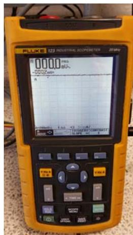
**Figura 10. Osciloscopio ScopeMeter FLUKE 123**
