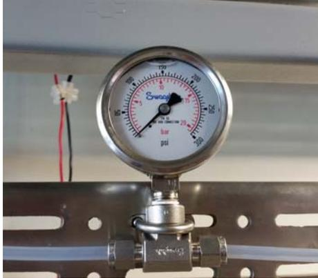
**Figura 19. Tee derivación hacia indicador de presión**
