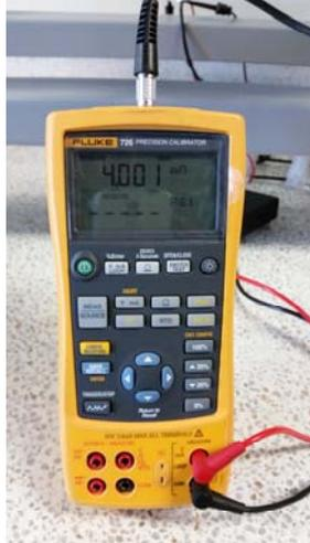
Figura 23. Modo MEASURE medidor corriente
