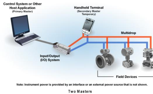
Figura 6. Configuración Multipunto
