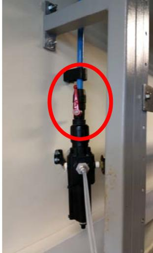
Figura 27. Válvula tipo bola en posición abierta.
