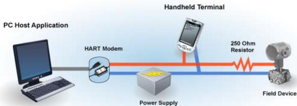
Figura 13. Conexión de un PC a un dispositivo HART
