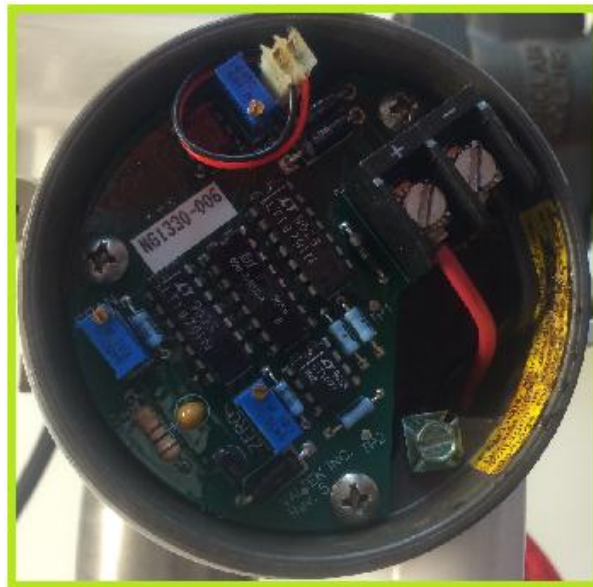
Figura 46. Del mantenimiento interno de la tapa del convertidor IP de alimentación. [Fuente: autor]
