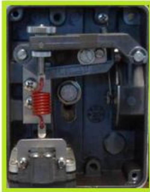
Figura 44. De la parte interna de la tapa del convertidor IP del ZERO y el SPAM. [Fuente: autor]
