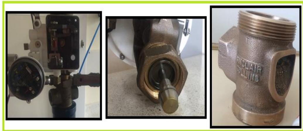
Figura 50. Corte de la válvula tipo globo. [Fuente: autor]
