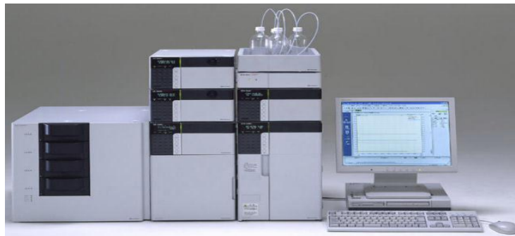
Figura 5. Equipo para análisis de cromatografía líquida de alta eficacia.
